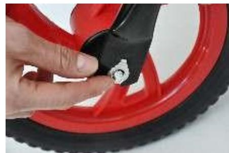
9. Sudejte matice a pojistné kroužky kol. Nasadte kolo na vidlici a vložte pojistné kroužky.
