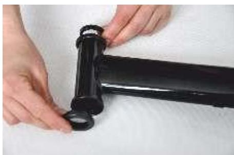
3. Připravte plastové objímky a umístěte je do horního otvoru v přední části rámu a do spodního otvoru. Objímky jsou stejně velké na obě dvě strany.
