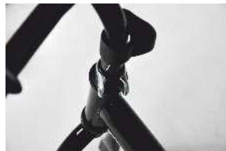
7. Zasuňte řídící tyč do vidlice. Tyč musí vychuhovat minimálně pod zohnutím tyče. Jinak nelze dobře dotáhnout objímka.
